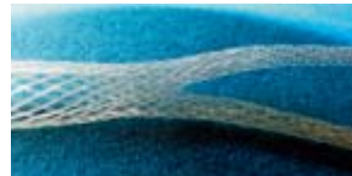
Geht nicht? Den Oldenburger Maschinenbauern ist es gelungen, auch das Herstellen von Verzweigungen zu automatisieren. Bilder: Alaxo/Herzog
